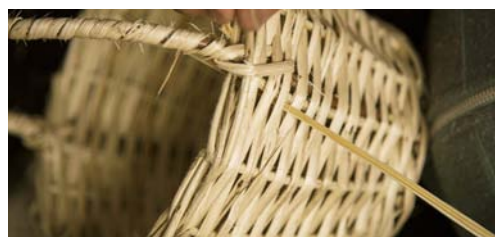
▲ Detalle de armado de arito de canasta. Puerto Montt.
